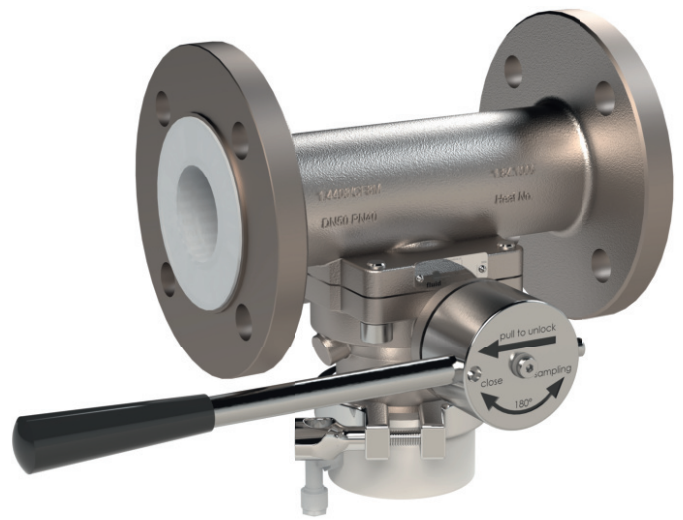
SSB Flansch / 1.4408-PFA / Handhebel 180°
